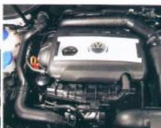
Mit 1,2 bar Ladedruck leistet der Wendland-GTI 260 PS
